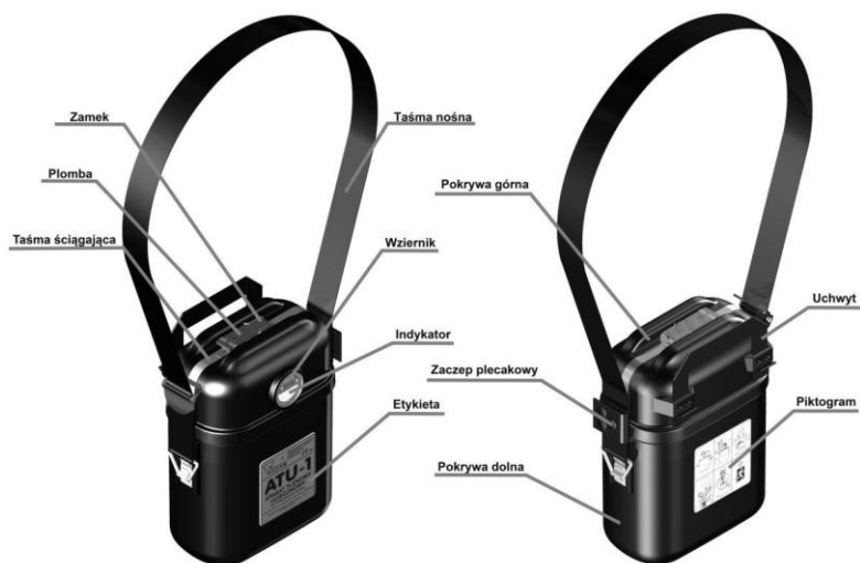
Rys. 1. APARAT TLENOWY UCIECZKOWY ATU-1 (zamknięty)
